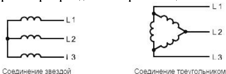
Рисунок 4 - Трехфазные трехпроводные электрические цепи
